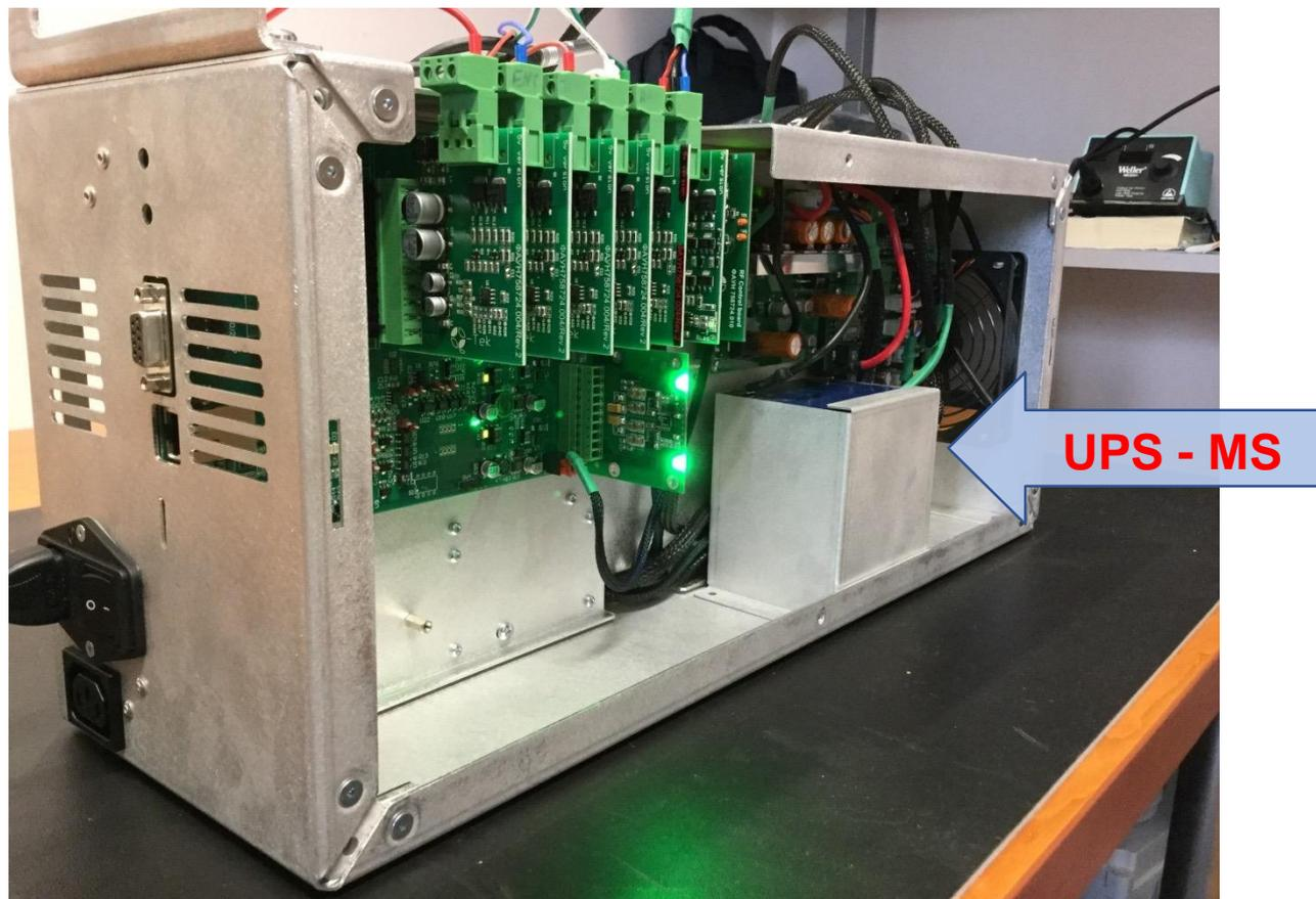
**UPS-MS** – автономное устройство защиты системы от бросков и перебоев в электропитании.
